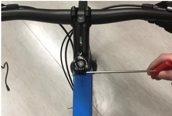
5. Rechte Schraube fest (halbe Umdrehung, 5 Nm)
