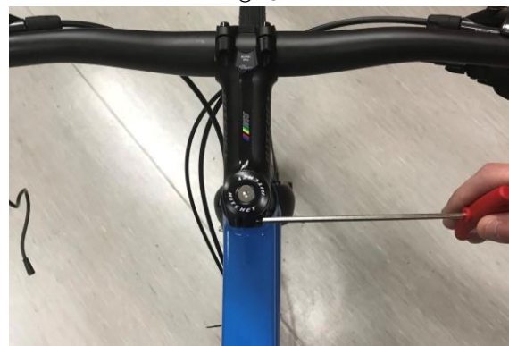
6. Linke Schraube fest (halbe Umdrehung, 5 Nm)
