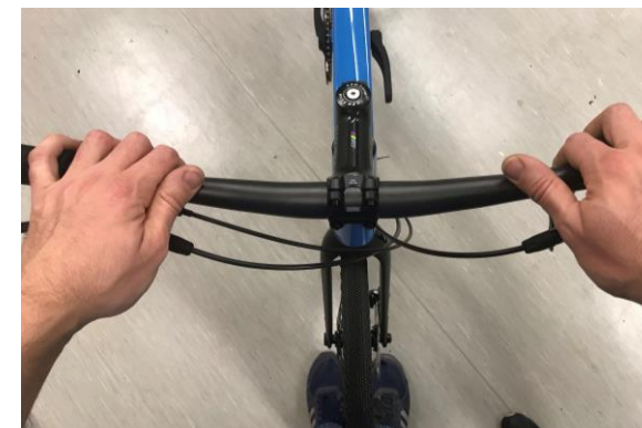
7. Klemme das Vorderrad fest zwischen die Knie und verdreh den Lenker nach beiden Seiten
